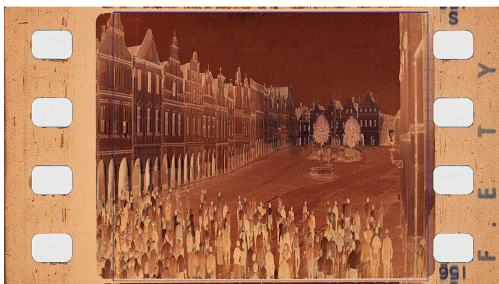
Obr. 1. Negativ a pozitiv filmu Až přijde kocour. Negativní surovina KODAK nezaznamenala takovou barevnou degradaci jako pozitivní surovina AGFACOLOR prezentovaná na původní kopii. Stav obou archiválií v roce 2015 při analýze na inspekčním stole Kinoton FVT 1200. Zdroj: Výzkum FAMU NAKI, 2015.
